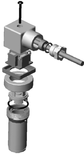
Illustration 1 – Vue en éclaté du connecteur
